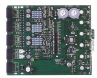
Модуль CZ-6 предназначен для подключения до 6 шлейфов с неадресными автоматическими пожарными извещателями System Sensor. Оконечное устройство неадресного шлейфа – резистор 3,9 кОм.
