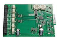
Модуль XP6-R предназначен для управления внешними устройствами (до 6 устройств) Имеет 6 независимых радиальных каналов управления с контролем цепи управления, либо 3 независимых кольцевых канала управления с контролем цепи управления. Имеет встроенный изолятор короткого замыкания. Занимает 6 или 3 из доступных 99 адресов на шлейфе. До 3 неиспользуемых выходов можно отключить для экономии адресов.
