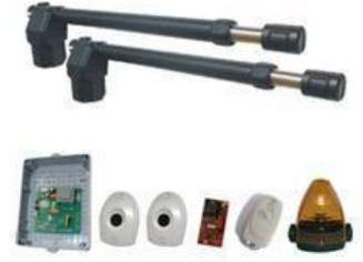
**Рычажные приводы** выполнены в виде электродвигателя с редуктором, который закрепляется на неподвижной части конструкции ворот (например, колонне) и рычага, крепящегося к створке ворот. Данный вид привода применяют, когда из-за конструкции ворот нельзя использовать линейный привод.
