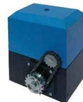
**Автоматика для ворот откатного типа** выполнена в виде электродвигателя с редуктором и ведущей шестерней. Такой механизм рекомендуется использовать при ограниченном пространстве около ворот. При этом сами ворота могут быть различной конструкции, с нижним расположением направляющего рельса, с верхним расположением рельса или консольного типа (подвесные без верхнего рельса).
