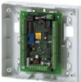
Модуль управления дверьми DCM в пластиковом корпусе (C080)
