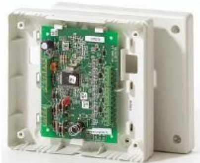
Расширитель проводных шлейфов / выходов RIO (C072)
