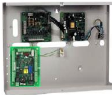
Расширитель беспроводных шлейфов RF PORTAL (C079-2)
