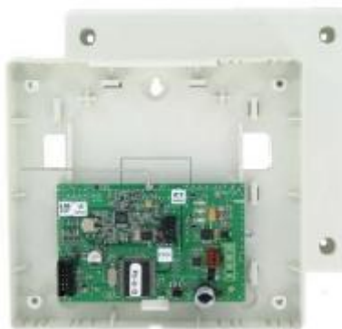
Расширитель беспроводных шлейфов RF PORTAL (C079-2)
